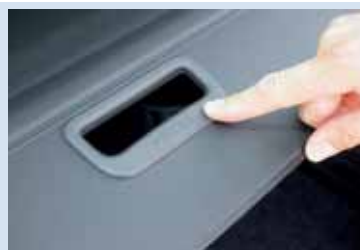
Zde stačí zatlačit a roletový kryt se automaticky navine na svou cívku
