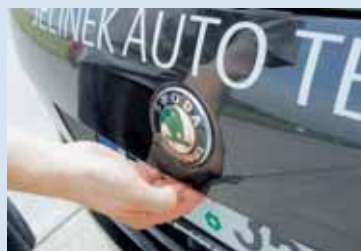
Madlo vnějšího zámku pátých dveří najdeme klasicky nad registrační značkou. Praktické přitahovací tykadlo je pro škodovky již typické.
