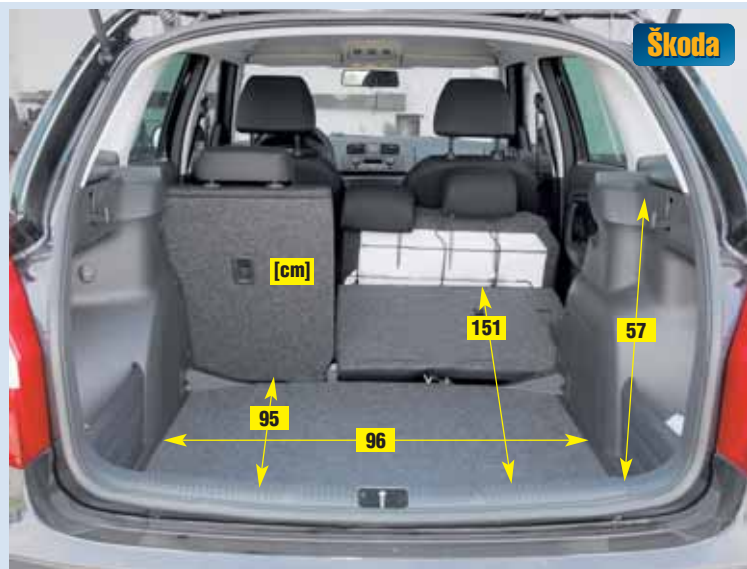
Mimořádně hluboký kufr škody pojme o 50 l zavazadel více než seat, ale přístupnost z ním zaostává. Systém sklápění zadního sedadla mají oba vozy shodný.
