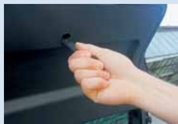
Madlo vnějšího zámku pátých dveří najdeme klasicky nad registrační značkou. Praktické přitahovací tykadlo je pro škodovky již typické.
